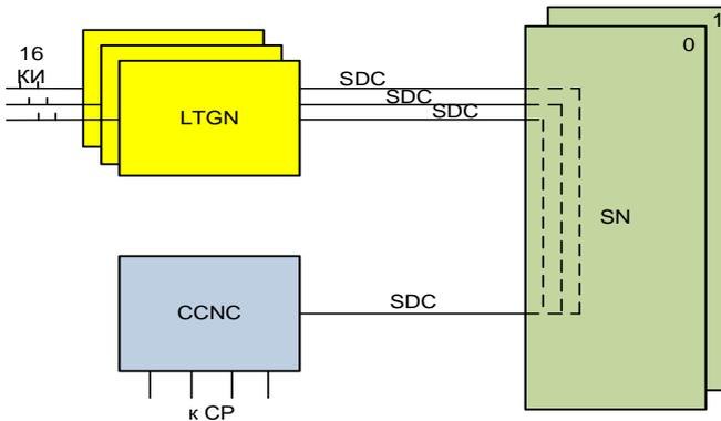
Рис. 10 – Схема подключения звеньев ОКС №7
