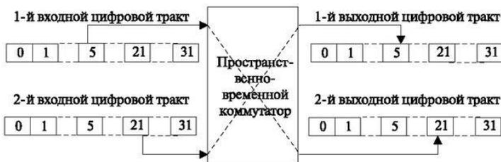
Рис 1 - Пространственно-временная коммутационная схема
