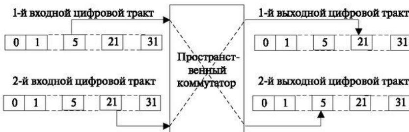
Рис. 2 – Работа пространственного коммутатора цифровых каналов
