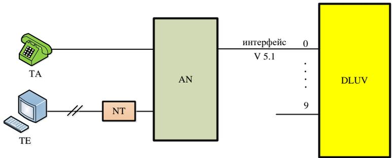
Рис. 8 - Схема подключения AN через DLUV
