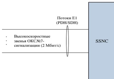
Рис. 11 – Схема подключения звеньев сигнализации ОКС №7 со скоростью 2 Мбит/с
