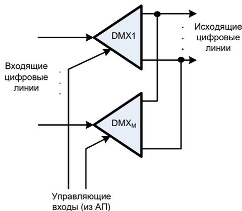
Рис. 6 - Схема пространственного коммутатора на демultipлексорах
