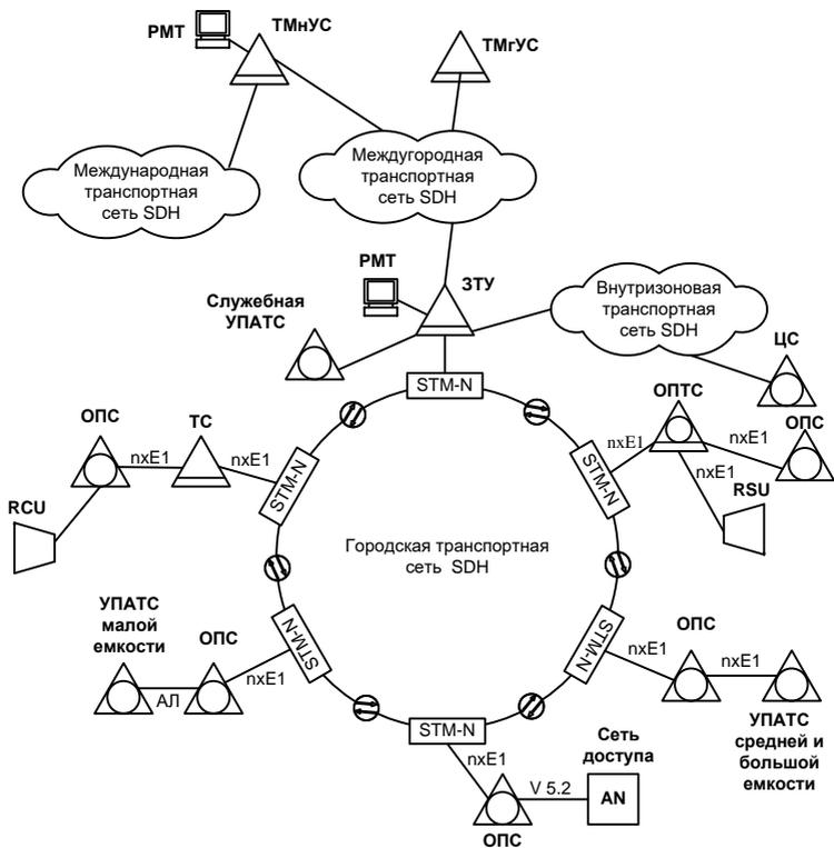
Рис. 2 – Схема возможных применений системы EWSД на сети связи
