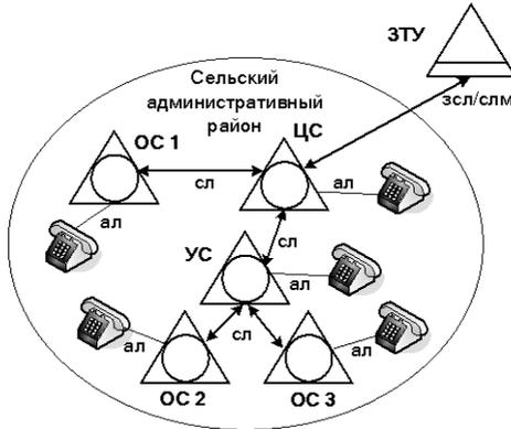
Рис. 6 – Радиально-узловая структура МТС
