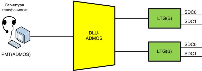
Рис. 9 - Схема подключения рабочих мест телефонисток
