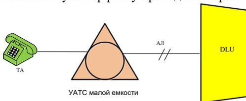
Рис. 4 – Схема подключения офисных УАПТС малой емкости
