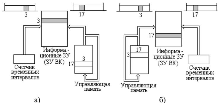
Рис. 9 Способы работы временного коммутатора:
