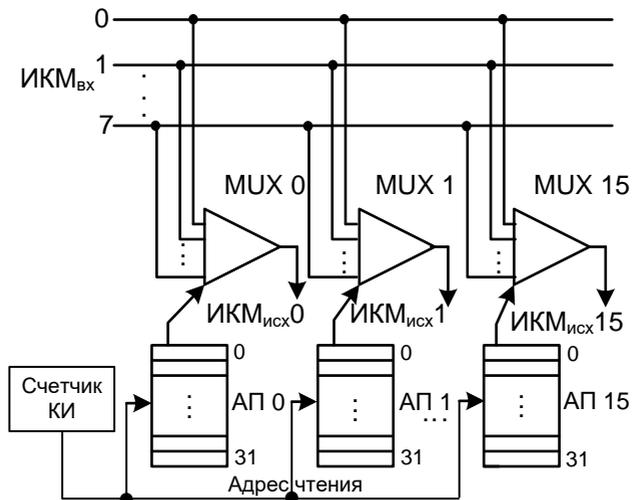
Рис. 5 - Схема пространственного коммутатора 8x16 на мультиплексо-рах
