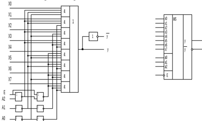
Рис. 3 - Мультиплексор на 8 входов: логическая схема и обозначение
