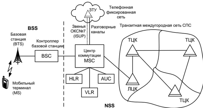
Рис. 7 – Фрагмент транзитной сети СПС стандарта GSM
