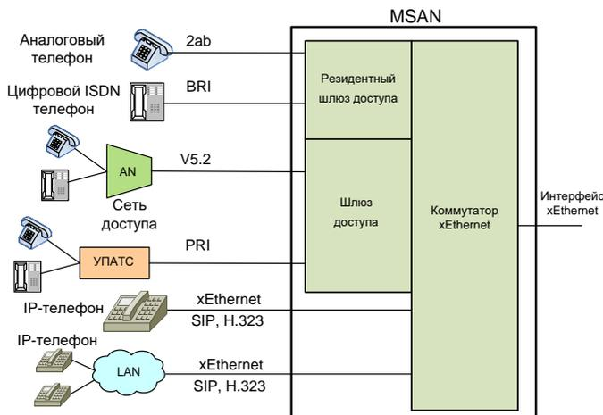
Рис. 1 – Структура мультисервисного узла доступа MSAN
