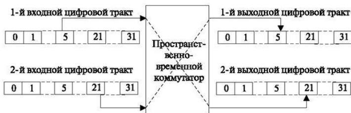
Рис 1 - Пространственно-временная коммутационная схема
