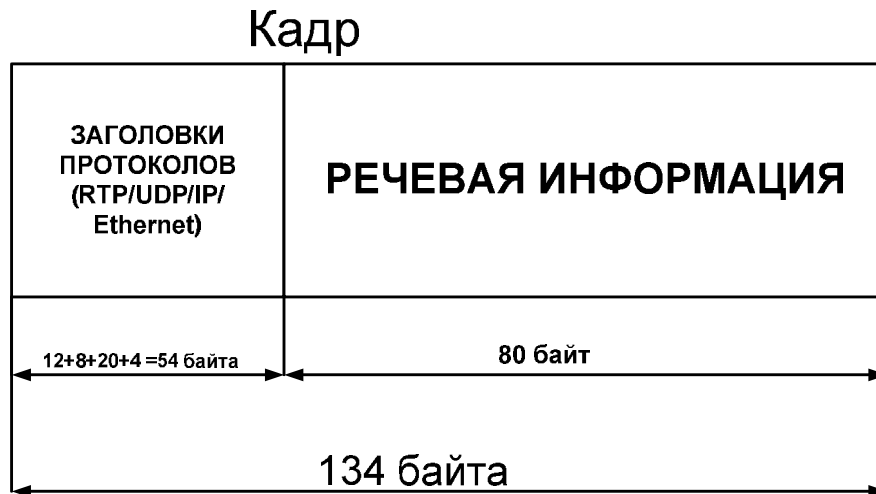
Рис. 13. Формат кадра G.711, передаваемого по IP сети
