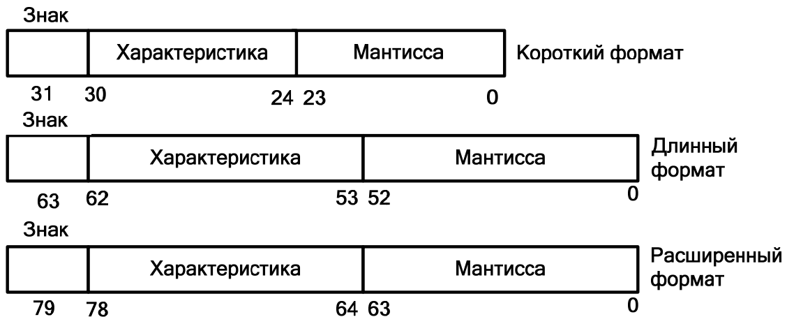
Рис. 1.19 – Формат чисел с плавающей точкой
