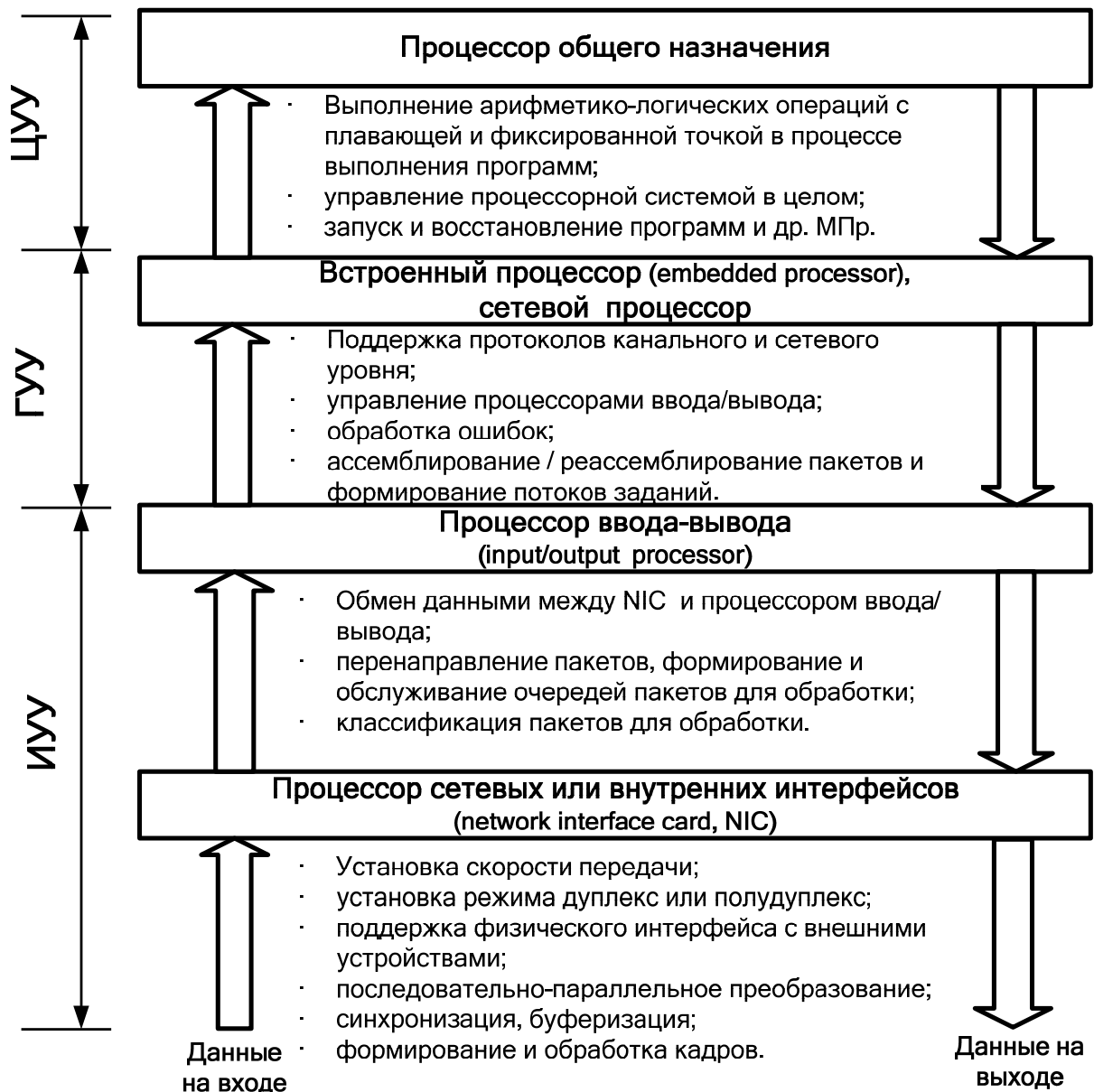
Рис. 1.9 – Функциональная иерархия процессоров в современных средствах связи [С учётом Wolf Tilman, курс ECE 697J, Univ. of Massachusetts Amherst, USA]
