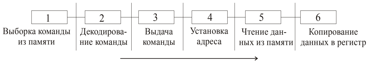
Рис. 5.3 – Пример разбиения команды «Считывание» данных из ОЗУ в регистр при конвейерной обработке данных
