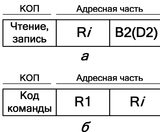
Рис. 1.28 а,б – Общая схема формата команд в системе RISC
