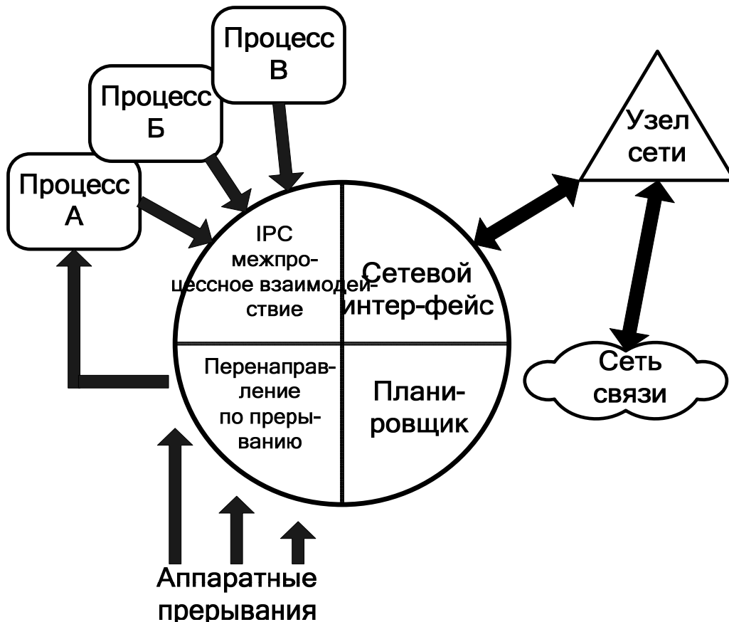
Рис. 2.6 – Микроядро ОС РВ на примере QNX версии 4.X [Источник www.aswl.ru/articles/rtos/gpo ]
