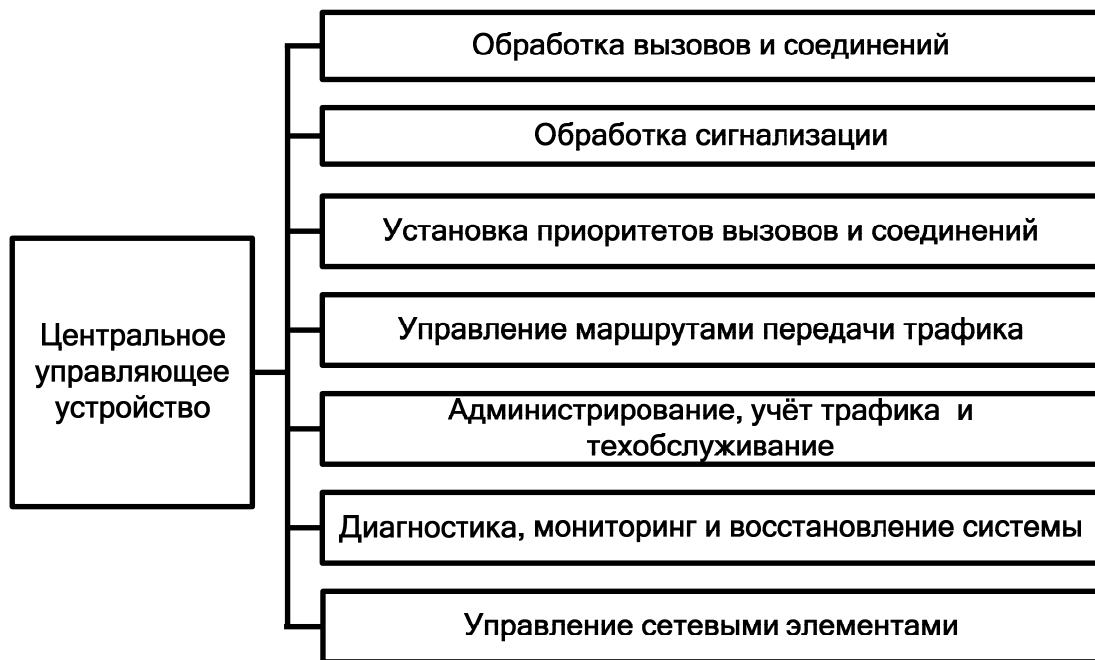
Рис. 1.5 – Централизованная функциональная архитектура УК средства связи
